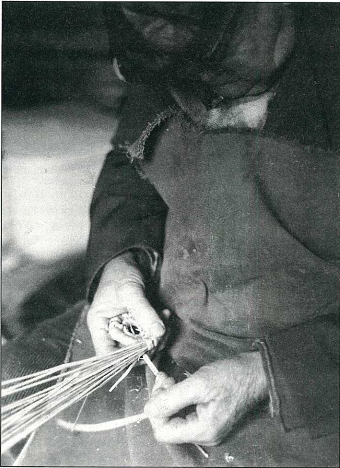
Hiver 1974 en Cévennes (basse Vallée Longue). Monsieur Rouquette, paysan vannier, fabrique une vannerie spiralee (Photo : J.-N. Pelen).
